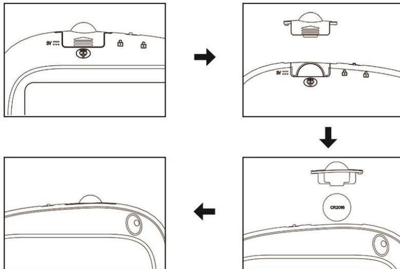
**Remplacement de la pile:** retirer la vis de sécurité et le support de la pile, retirer la pile, insérer une nouvelle pile bouton CR 2016 [3V] et réinsérer le support de la pile dans la fente.
